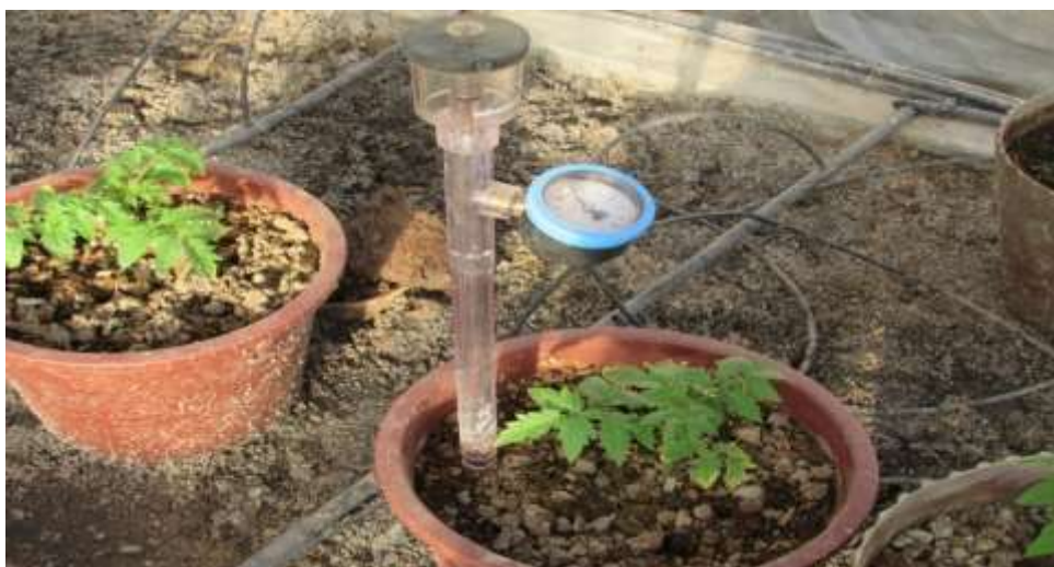
شکل ۵- قرائت مقادیر رطوبت در گلدان‌ها به وسیله تانسومتر
