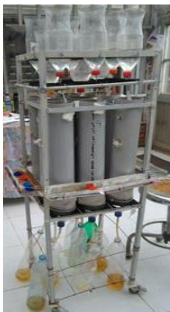
شکل ۱- ستون‌های خاک در حال آبشویی، ظروف بالای ستون محل آب ورودی و ظروف پایین دستگاه، برای جمع‌آوری زهاب حاصل از آبشویی می‌باشد.
