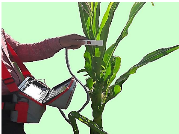
شکل ۱- نحوه اندازه‌گیری مقدار مقاومت روزنه‌ای برگ‌های ذرت با دستگاه پرومتر AP4
