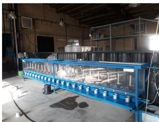
شکل ۲- نمای کلی دستگاه ۲۰ واحد در حال اندازه‌گیری تراوش گسیلنده‌ها در آزمایشگاه هیدرولیک مؤسسه فنی و مهندسی
