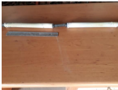
شکل ۱- نمایی از دو قطعه گسیلنده سفالی که توسط یک لوله پلی اتیلن به قطر ۱۶ میلی‌متر به هم متصل شده‌اند
