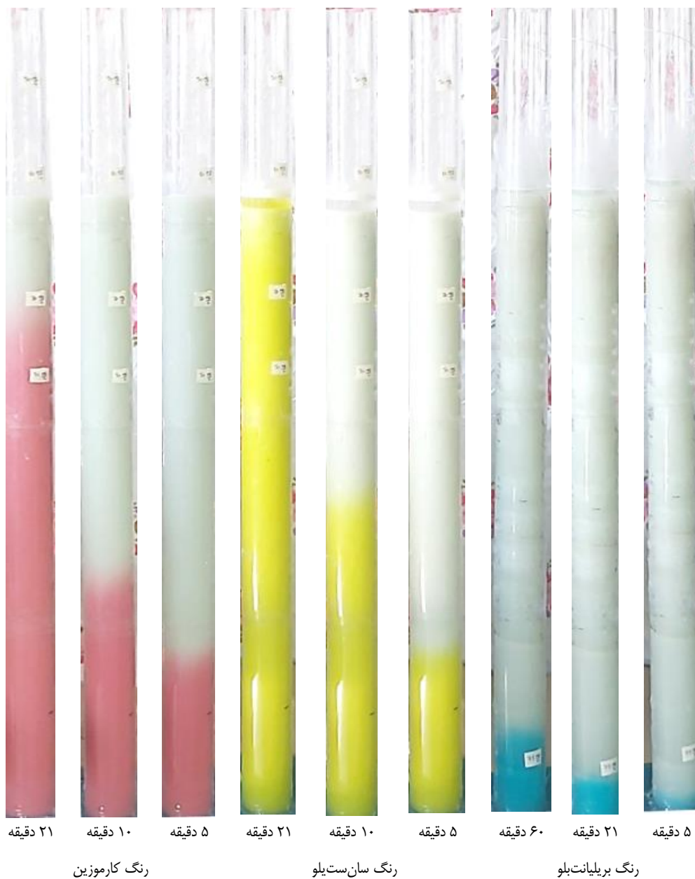
شکل ۷- نحوه حرکت آب شور رنگ آمیزی شده با انواع مختلف رنگ‌ها نسبت به زمان در استوانه حاوی گلس بید ریزدانه
