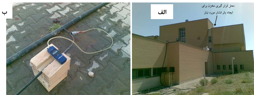
شکل ۱- (الف) محل قرارگیری مخزن برای ایجاد بار فشارمورد نیاز و (ب) فشارسنج برای اندازه‌گیری فشار در مانیفلدها
