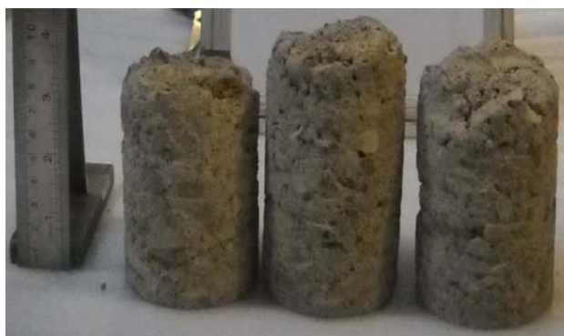
شکل ۲: مغزه‌های اخذ شده از کانال گنده‌جین
