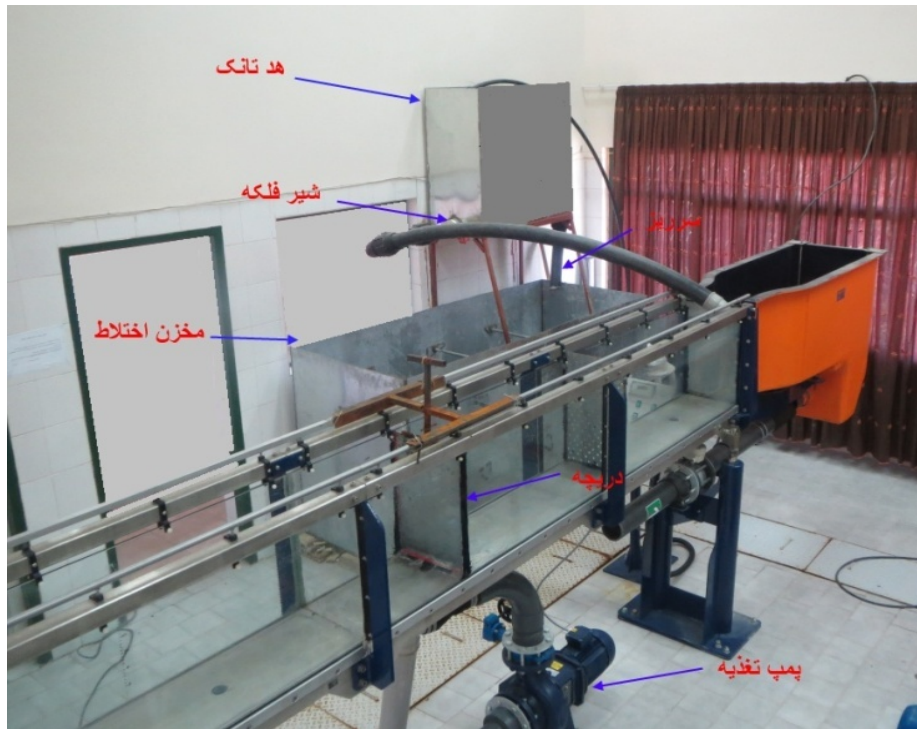
شکل ۲- فلوم آزمایشگاهی و متعلقات آن
