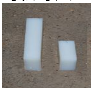
شکل 2- نمایی از ضد گرداب مستطیلی (نوع A) در طول‌های مختلف
