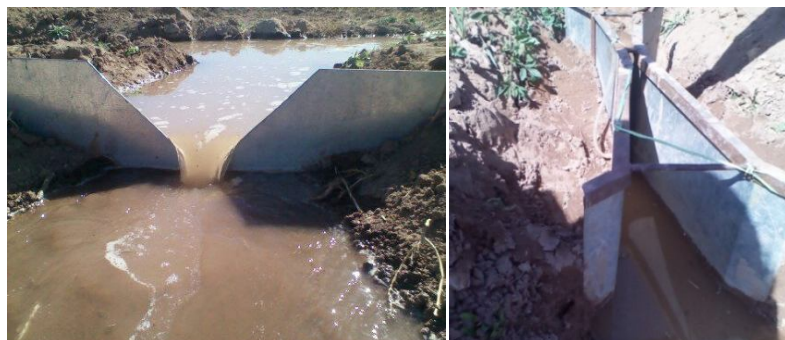
شکل 3- نحوه اندازه گیری دبی ورودی و خروجی در جویچه مزرعه تحقیقاتی دانشگاه باهنر کرمان.
