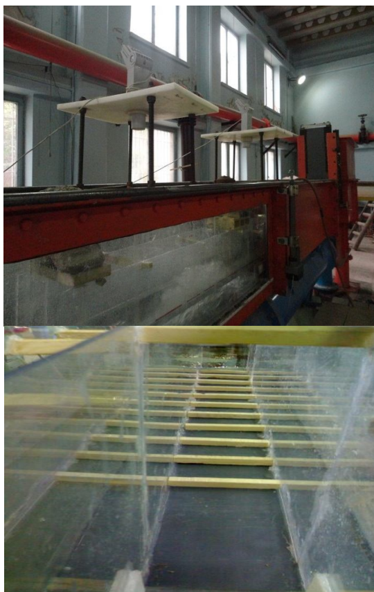
شکل 1- نمایش فلوم آزمایشگاهی و بستر زبر مکعب مستطیل نواری
