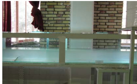
شکل ۱- الف: شکل شماتیک فلوم آزمایشگاهی، (ب): شکل شماتیک حوضچه و (ج): تصویر حوضچه و تعبیه صفحات کفی با زاویه ۶۰ درجه
