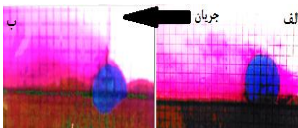
شکل ۸- توسعه و توزیع جریان در لوله بدون اسپویلر (الف) و با اسپویلر (ب)
