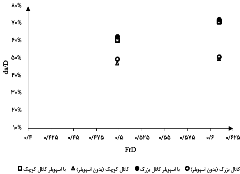
شکل ۱۱- مقایسه درصد دفن شدگی لوله با قطرهای مختلف به عدد فرود لوله (در کانال کوچک و بزرگ)
