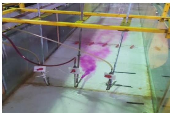
شکل ۴- نمایی از لوله‌های I شکل برای انتقال ماده ردیاب
