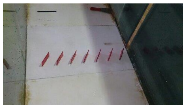
شکل ۶- نمایی از محل قرارگیری صفحات مستغرق ۷ تایی در صفحه پی‌وی‌سی
