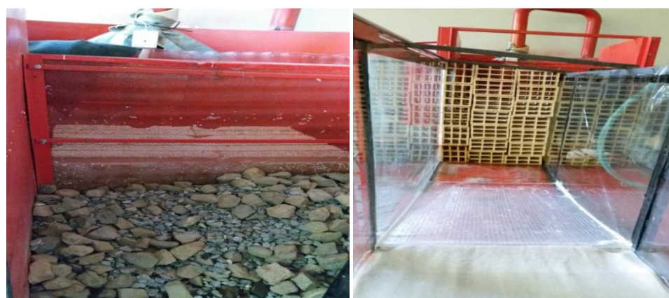
شکل ۲- مصالح استفاده شده برای کاهش تلاطم کانال
