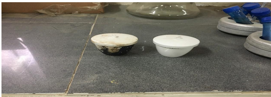
شکل ۲- ظرف درپوش دار مخصوص تولید بیوچار و هیدروچار باگاس نیشکر
