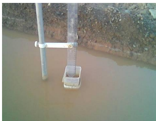
شکل ۸- ابزار اندازه‌گیری عمق آب
