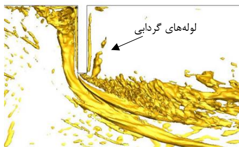
شکل ۱۰- مشاهده ساختارهای چرخشی جریان لحظه‌ای در اطراف آبشکن با استفاده از معیار Q در نمای بالا
