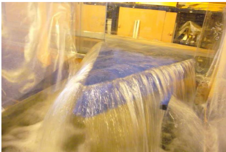
شکل ۲- نمونه‌ای مدل آزمایشگاهی سرریز جانبی کنگره‌ای (زاهدی خامنه، ۱۳۹۱)
