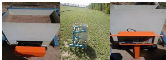
شکل ۲- میکرو لایسیمتر مورد استفاده در مزرعه تحقیقاتی بردسیر (عکس توسط محققین تهیه شده است)
