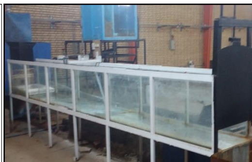
شکل ۲- فلوم آزمایشگاهی در تحقیق حاضر
