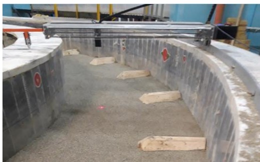
شکل ۳- دستگاه سنجش توپوگرافی بستر
