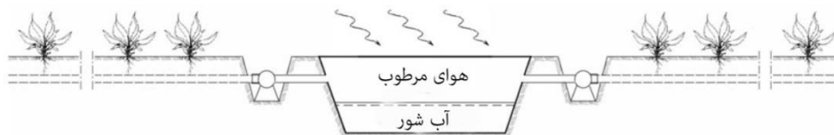
شکل ۱- طرح شماتیک آبیاری چگالشی که لوله‌های منفذدار مدفون در محیط ریشه به دستگاه رطوبت‌ساز متصل هستند (Lindblom and Nordell, 2007)
