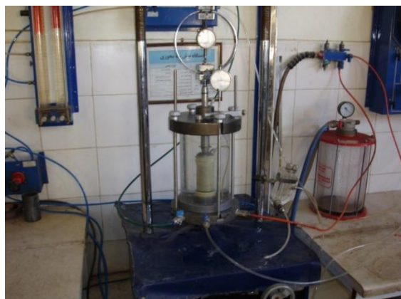
شکل ۳- نمای کلی دستگاه سه‌محوری فشاری
