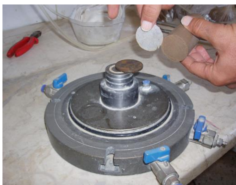
شکل ۴- نمونه صفحات متخلخل و فیلتر کاغذی
