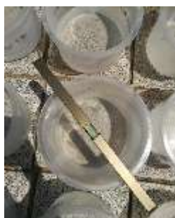
شکل ۲- آماده سازی و تراز کردن ظروف تعیین تبخیر
