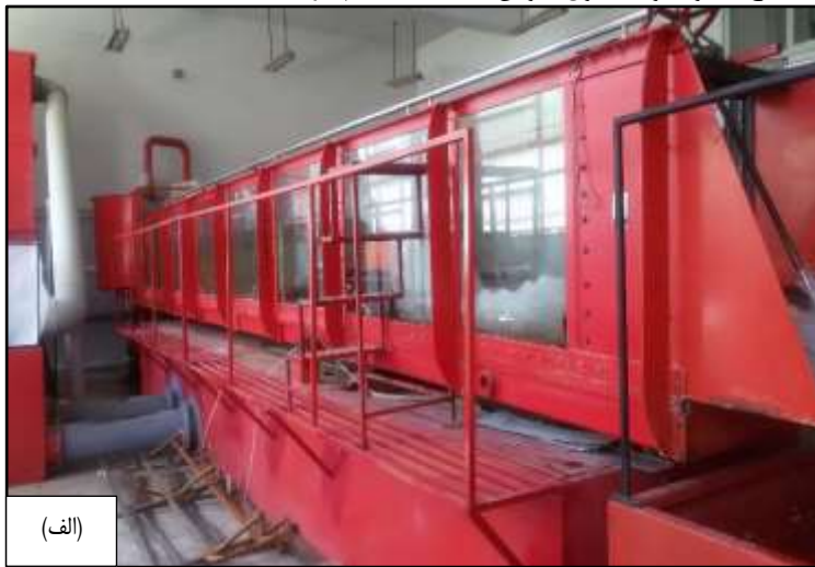
شکل ۳- نمایی از تجهیزات و مدل فیزیکی (الف) فلوم آزمایشگاهی تحقیق حاضر (ب) مدل فیزیکی سرریز به ارتفاع ۱۵ سانتی‌متر
