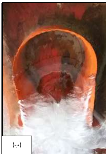
شکل ۳- نمایی از تجهیزات و مدل فیزیکی (الف) فلوم آزمایشگاهی تحقیق حاضر (ب) مدل فیزیکی سرریز به ارتفاع ۱۵ سانتی‌متر
