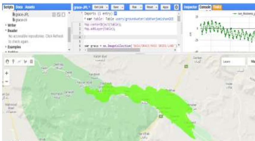
شکل ۲- اجرای مدل GRACE با مرکز پردازش داده JPL در آبخوان میانراهان در محیط گوگل ارث اینجین
