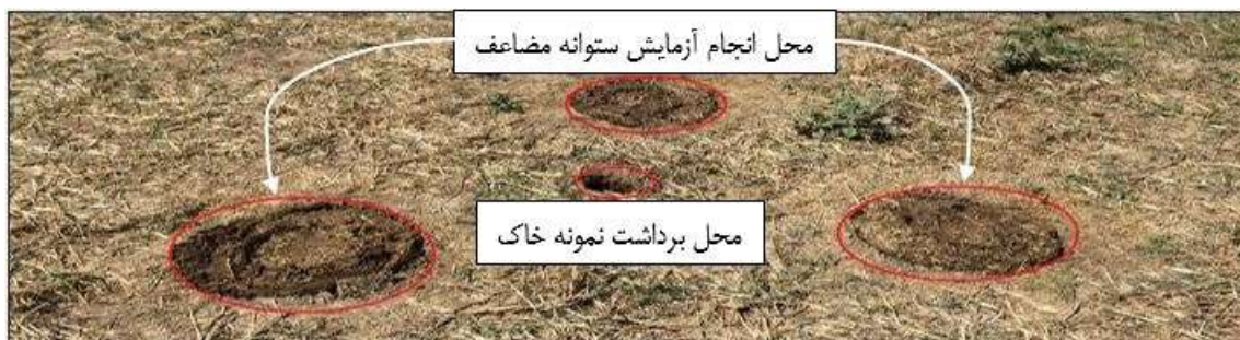
شکل ۲- نحوه انجام آزمایش‌ها و تهیه نمونه خاک در محل
