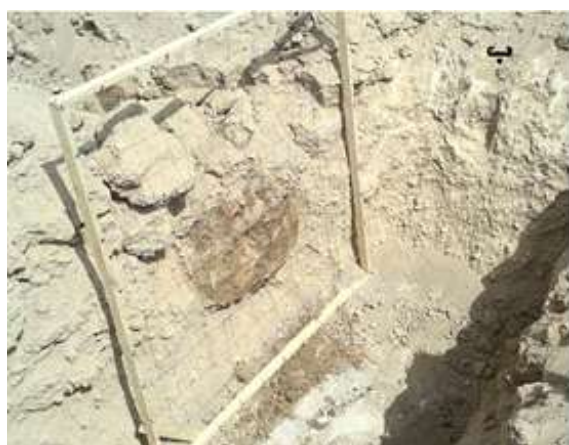
شکل ۳- (الف) جبهه رطوبتی ایجاد شده و (ب) استفاده از چهارچوب مشبک برای اندازه گیری ابعاد پیاز رطوبتی
