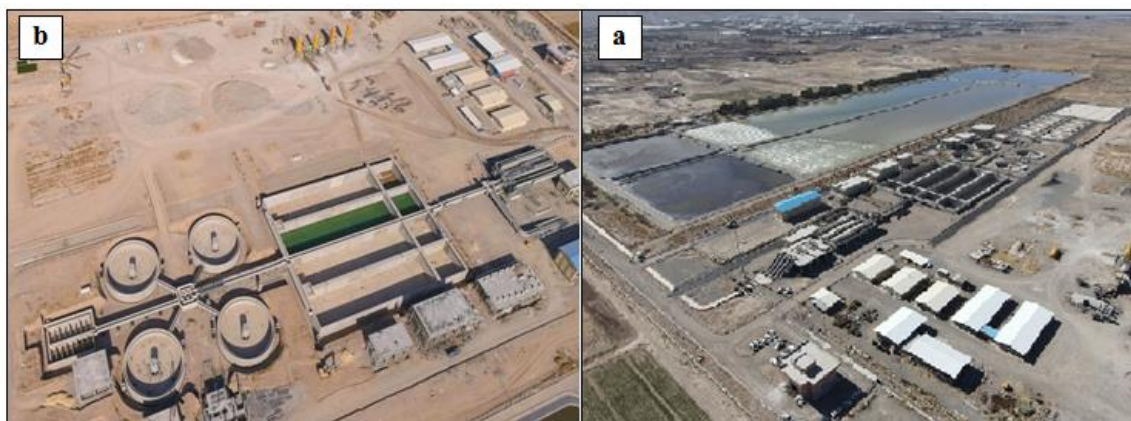
شکل ۲- تصفیه خانه فاضلاب بیرجند (a: مدول ۱ روش برکه‌های تثبیت بیولوژیکی و b: مدول ۲ روش لجن فعال)
