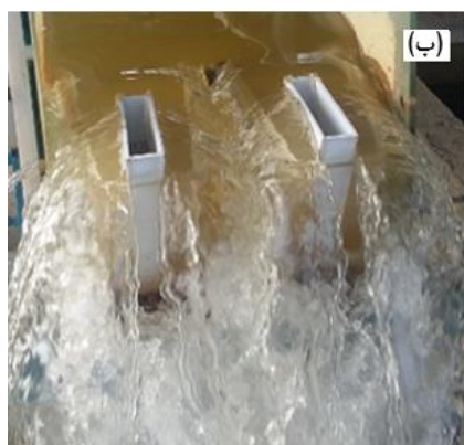
شکل ۹- جریان عبوری از فیوز گیت NLH در موقعیت نصب شده در (الف) میانه و (ب) انتهای کانال
