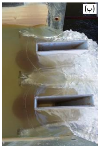
شکل ۸- جریان عبوری از فیوز گیت WLH در موقعیت نصب شده در (الف) میانه و (ب) انتهای کانال
