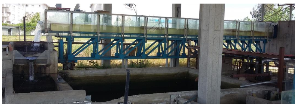
شکل ۵- تصویر کلی سیستم گردش آب در کانال مورد استفاده در آزمایش‌ها
