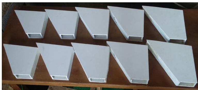
شکل ۷- تعدادی از چاهک‌های ساخته شده با ارتفاع‌های متفاوت
