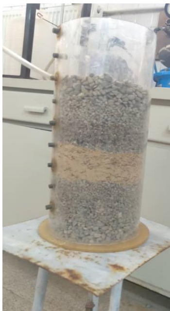
شکل ۱- مدل فیزیکی با لایه‌های مختلف فیلتر سیلیس و جاذب بین آن‌ها
