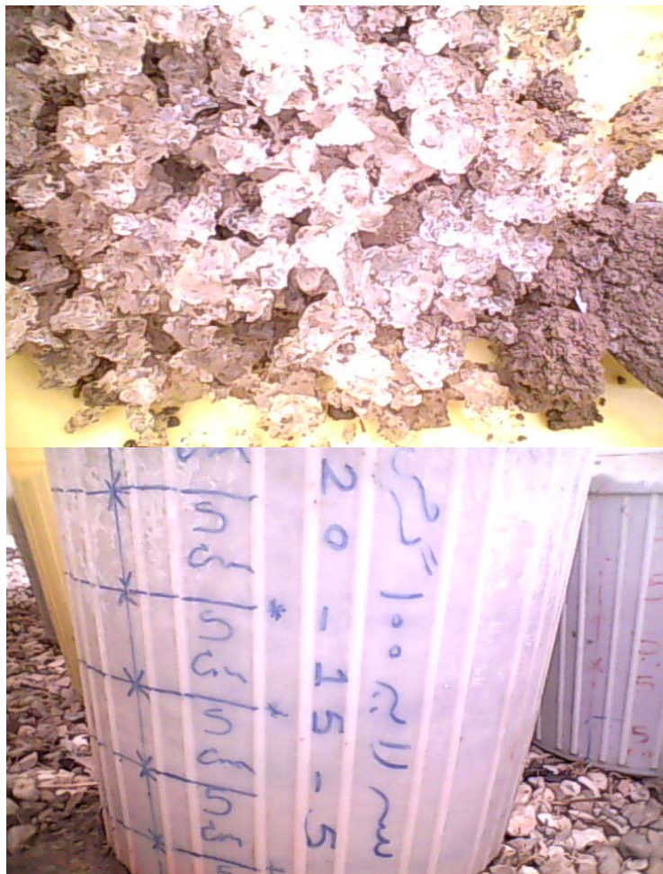
شکل ۱ - ظروف مورد استفاده جهت انجام آزمایش و تورم پلیمر در خاک جدول ۱ - برخی خصوصیات فیزیکی خاک مورد استفاده
