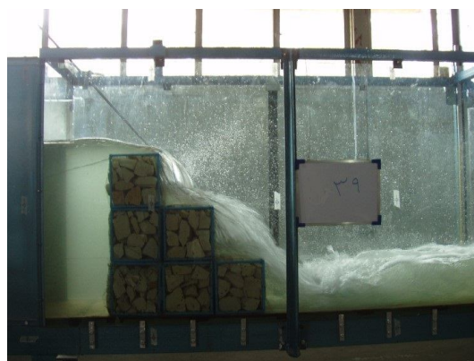
شکل 8- نمونه آزمایش بر روی مدل سرریز پلکانی گابیونی
