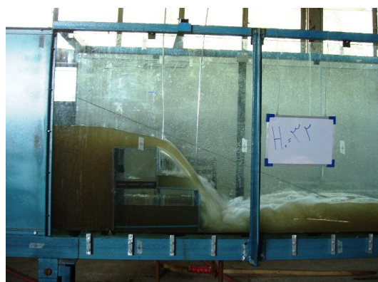
شکل 7- نمونه آزمایش بر روی مدل سرریز پلکانی صلب
