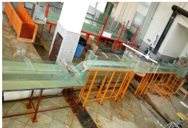
شکل ۲- نمایی از مدل آزمایشگاهی حوضچه رسوب گیر گردابی
