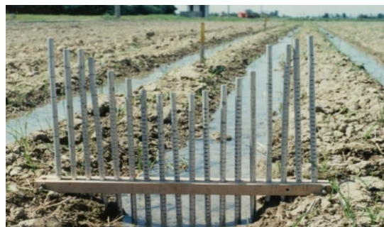
شکل ۱- نمای دستگاه انتقال آب به جویچه‌های آزمایشی
