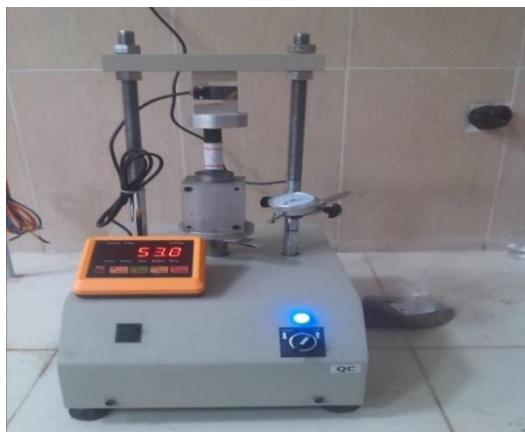
شکل ۴- متراکم کردن نمونه درون قالب با سرعت ۱/۵ میلیمتر بر دقیقه
