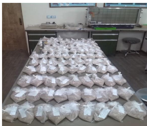
شکل ۳- تهیه نسبت های اختلاط مختلف به صورت خشک
