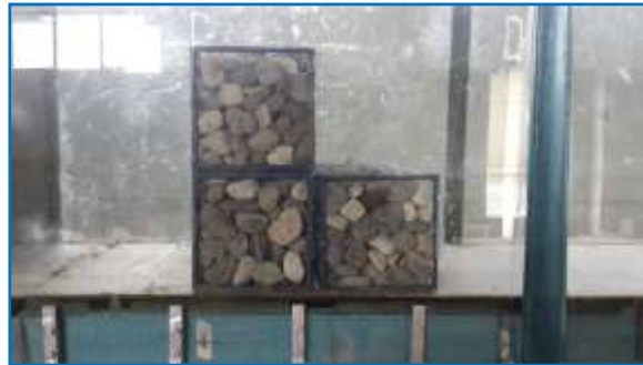
شکل ۳- نصب مدل سرریز گابیونی ۲ پله در فلوم آزمایشگاهی
