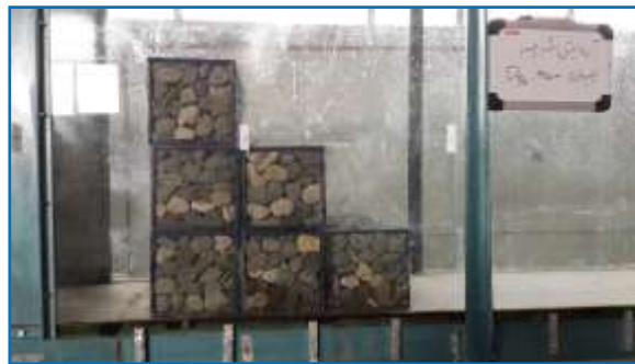
شکل ۴- نصب مدل سرریز گابیونی ۳ پله در فلوم آزمایشگاهی
