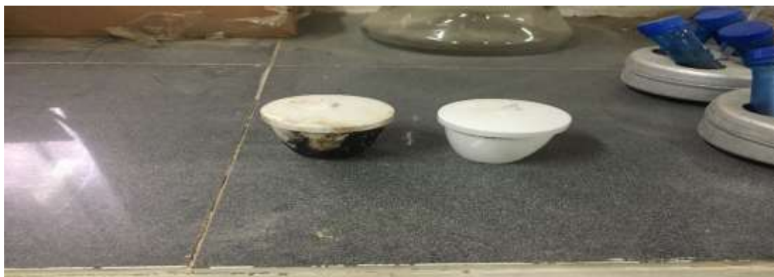
شکل ۳- ظرف درپوش دار مخصوص تولید بیوچار و هیدروچار باگاس نیشکر
