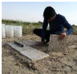
شکل ۲- آماده سازی و تراز کردن ظروف تعیین تبخیر
