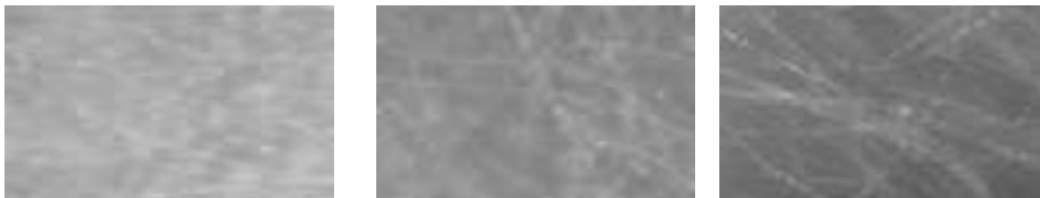
شکل ۱۵ - تصاویر میکروسکوپی نانوفکوس از سطح توده الیاف الکترورسی شده پلیمر PMMA با حلال DMF (C2) با دستگاه الکترورسی DC تحت شدت تغذیه‌های مختلف ۰/۵ (Low) ml/h، ۱ (Moderate) ml/h و ۲ (High) ml/h
