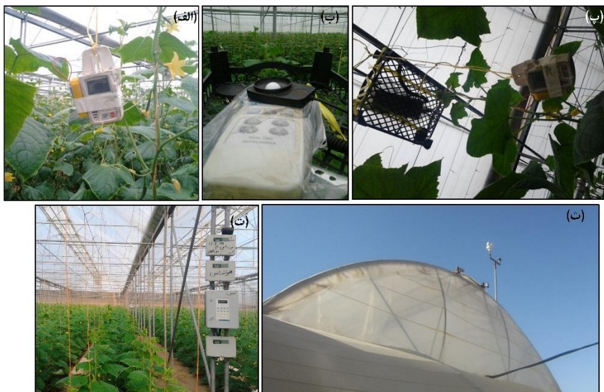
شکل ۲- (الف) دیتالاگر دما و رطوبت نسبی testo 175 H2؛ (ب) لوکس متر YK-2005LX؛ (پ) قرارگیری دیتالاگرهای دما و رطوبت نسبی و لوکس متر در مرکز محل آزمایش؛ (ت) سامانه اتوماسیون گلخانه؛ (ث) بادسنج
