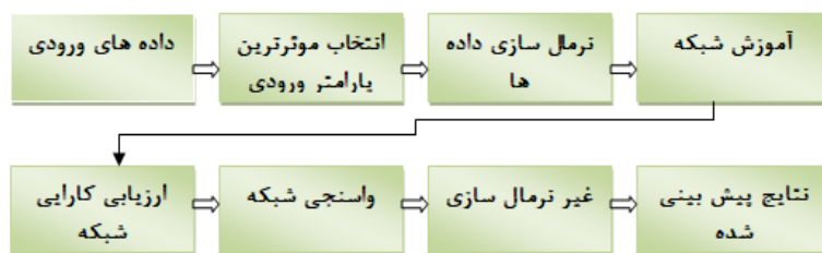
شکل ۲- شمای کلی از روند مراحل مدل‌سازی به روش ANN
