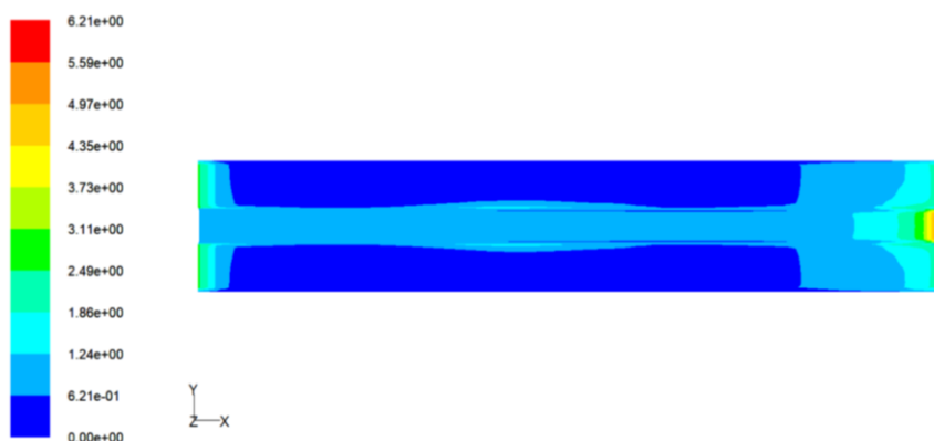
شکل ۱۴- نتایج عددی تنش برشی بستر در طول کانال برای نمونه ۳ (سری ۷)
