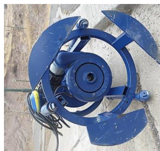
شکل ۷- نازل جت آب (تعداد: ۳ عدد، قطر: ۵ میلی متر، زاویه: ۴۵°)
