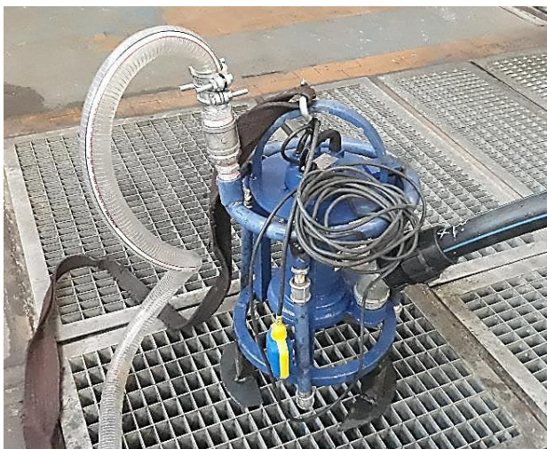
شکل ۸- شکل نهائی سیستم لایروبی ساخته شده برای آزمایش‌های میدانی
