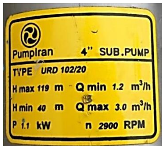
شکل ۶- الف: پمپ شناور، ب: مشخصات فنی (pumpiran.com)
