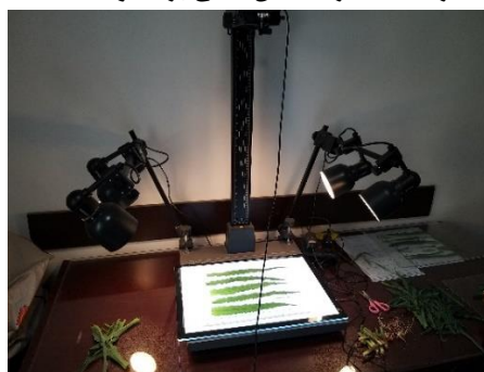
ج) اندازه‌گیری سطح برگ توسط دستگاه سطح‌سنج Delta T
