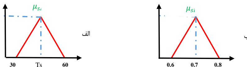
شکل ۹- نمودار تابع عضویت الف) محدودیت حجم مخزن و ب) قابلیت اطمینان حجم مخزن - فصل بهار
