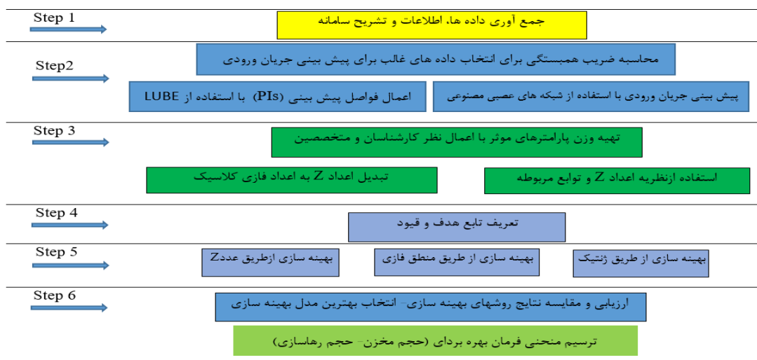
شکل ۲- فرآیند مدل سازی و توسعه یک مدل بهینه بهره برداری از مخازن سدها از طریق اعداد Z
