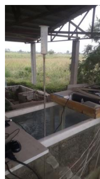
شکل ۹- نحوه تزریق ماده رنگی به داخل بستر رسوبی
