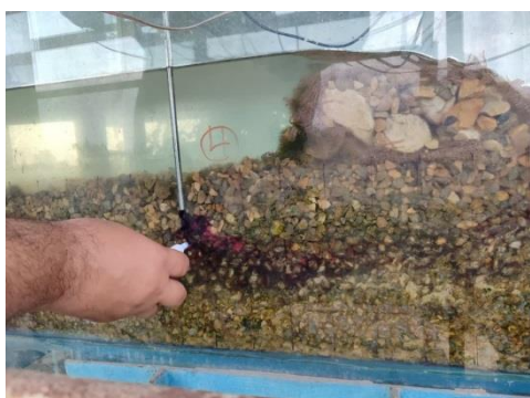
شکل ۱۰- ماده رنگی تزریق شده به ناحیه زیرین در بالادست یک سازه پره متقاطع و نحوه شکل گیری ناحیه هایپریک
