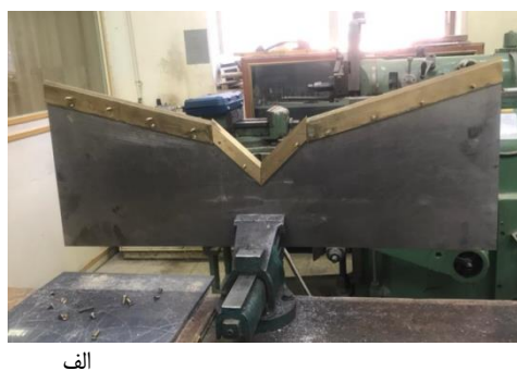
شکل ۱ - سرریز مرکب مثلثی - مثلثی مورد مطالعه: الف) مدل ساخته شده در کارگاه ب) طرح شماتیک سرریز
