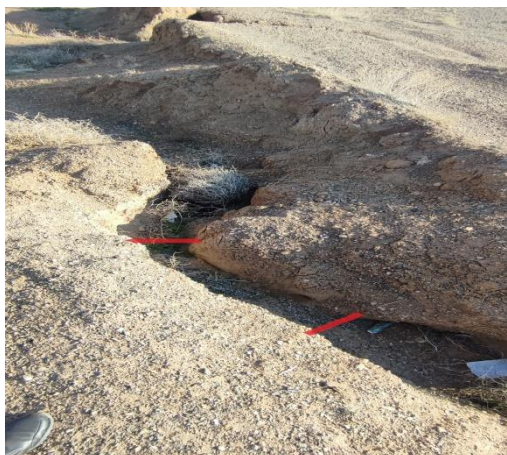
شکل ۱۰- ترک های طولی گسترش یافته در محدوده حاجی آباد
